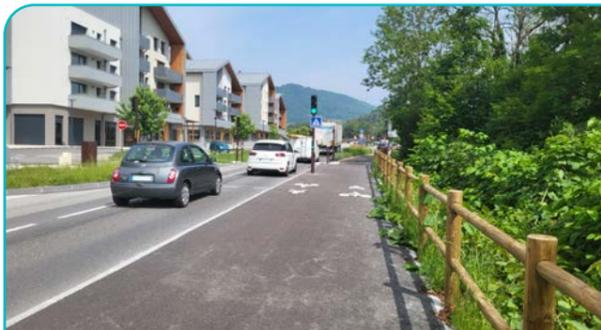
**Route de la Vallée du Giffre** : des feux à détection ont été mis en place pour réguler et sécuriser les automobilistes, au niveau de la sortie des immeubles de Soren et des différents commerces situés sur cette zone. Les feux se déclenchent par la détection d'un véhicule en approche à l'aide d'un capteur. Un marquage au sol indique la zone de détection.
